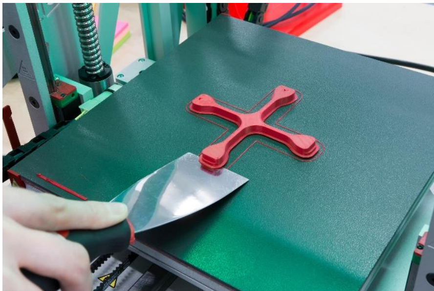
Rys. 37 Prawidłowe postępowanie przy zdejmowaniu modelu z drukarki
