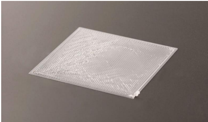
Rys. 34 Przykład zbyt wysokiego ustawienia stołu roboczego
